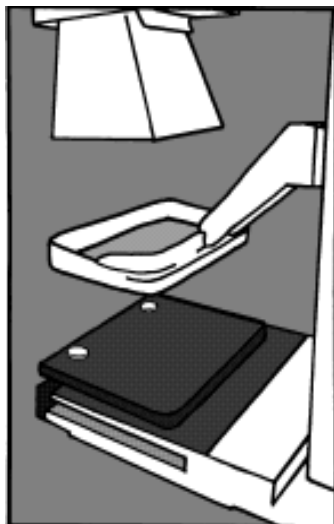
2.3 ábra: Sugármező-fénymező egybeesésének vizsgálati módja
